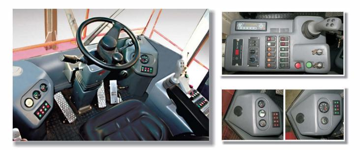
驾驶室内座椅采用全悬浮减震结构,可做全方位的调节:各操作踏板、手柄位置按人体工程学原理设计,可大大降低 劳动强度;加大司机室设计,四面全明玻璃,视野开阔,配冷暖空调。
