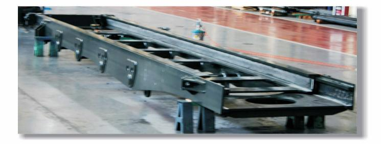
吊具:采用瑞典ELME公司的新型吊具,该吊具采用优质钢制造,单筒式结构,强度高,视野好,带安全互锁功能。可实现侧移、伸缩和开闭锁等动作,并有吊具状态指示,辅助灯光照明等功能。
